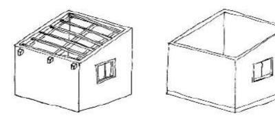
Totalmente Destruída (Há danos estruturais na cobertura e nas paredes. O telhado foi parcial ou completamente removido)
