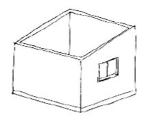
Totalmente Destruída (Há danos estruturais na cobertura e nas paredes. O telhado foi parcial ou completamente removido)
